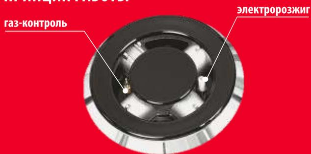
Система газ-контроль представляет собой термопару, состоящую из нескольких элементов различной теплопроводности, электромагнитную катушку и запорный клапан. Теплоприемник термопары размещен в зоне горения пламени.
